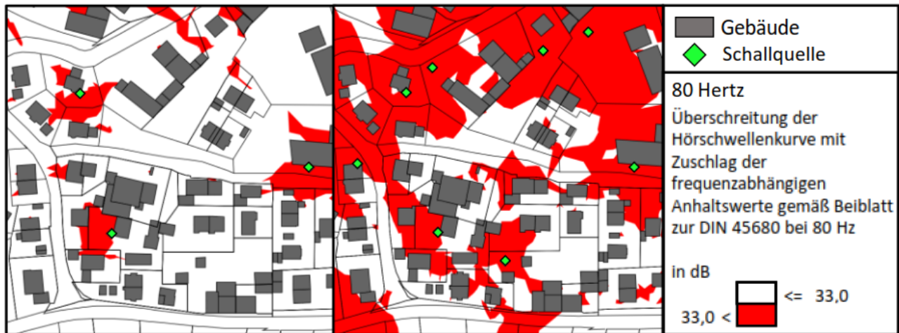
Abbildung 4: Potentielle Konfliktbereiche für tieffrequente Geräusche im Mustergebiet MD für die 80 Hz-Terz (links: Bestand 2014; rechts: Prognose 2030)
