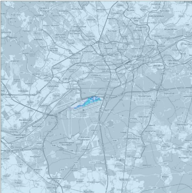
Abbildung 52: Jahresmittel 2015 der bodennah berechneten Konzentration von PM 2,5 in µg/m 3 für die Quellgruppen Kfz-Verkehr des Umlandes, Flugbetrieb und Bodenabfertigung, Hintergrundbelastung sowie Gesamtbelastung.
