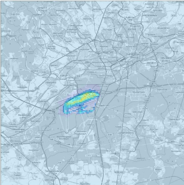
Abbildung 53: Jahresmittel 2015 der bodennah berechneten Konzentration von Ruß in \mu\text{g}/\text{m}^3 für die Quellgruppen Kfz-Verkehr des Umlandes, Flugbetrieb und Bodenabfertigung, Hintergrundbelastung sowie Gesamtbelastung.
