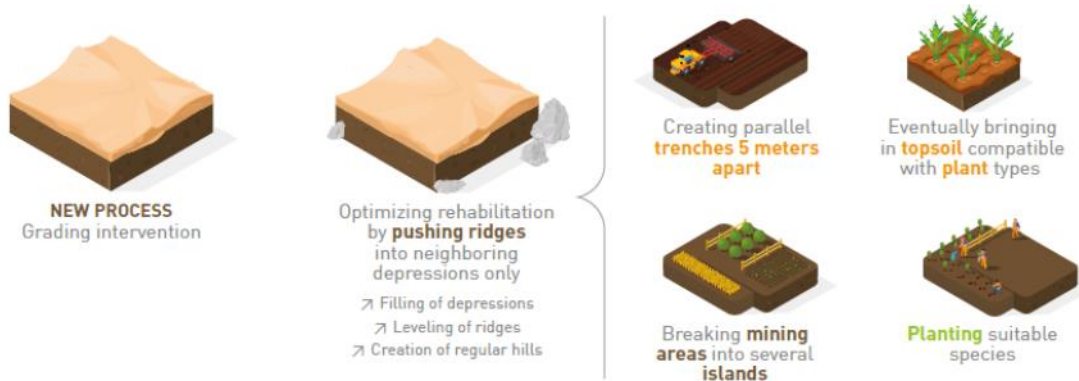
Abbildung 13-17: Schema zur Renaturierung der marokkanischen Minen
