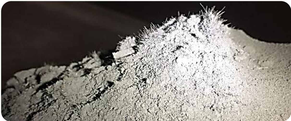
Abbildung 105: Carbonfasern im UVO-Staub während der Verwertung von 10 Mg CFK-Pellets/d.
