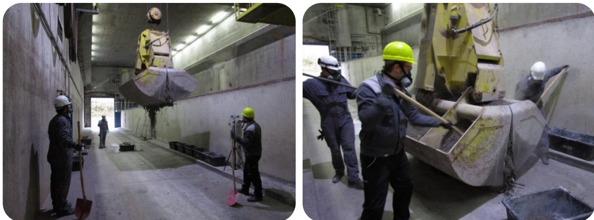
Abbildung 19: Beprobung der Rostasche aus dem Krangreifer während der Kontrollmessung.
