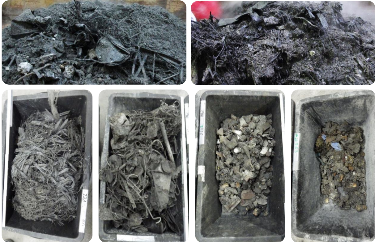
Abbildung 64: Rostaschen im Versuchszeitraum Referenz (links, oben) und CF-Mitverbrennung (rechts, oben); gesiebte und sortierte Materialien > 30 mm aus dem Versuchszeitraum CF-Mitverbrennung (unten, vlnr: CF, Metalle, Steine, Unverbranntes).
