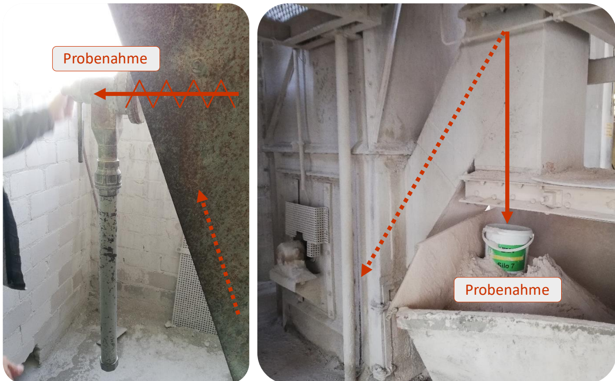
Abbildung 38: Probenahmestellen für Rohmehl (links) und Filterstaub (rechts).
