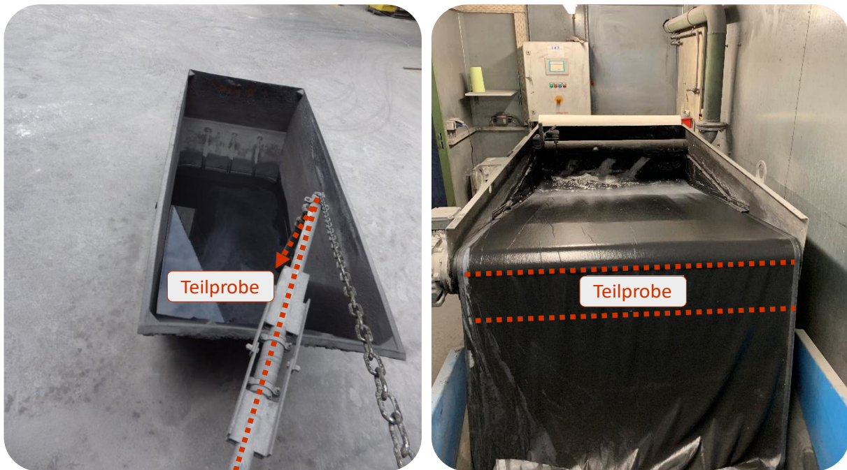
Abbildung 44: Beprobung des Filtrats aus dem Schrägklärer (links) und des Bandfilters (rechts).
