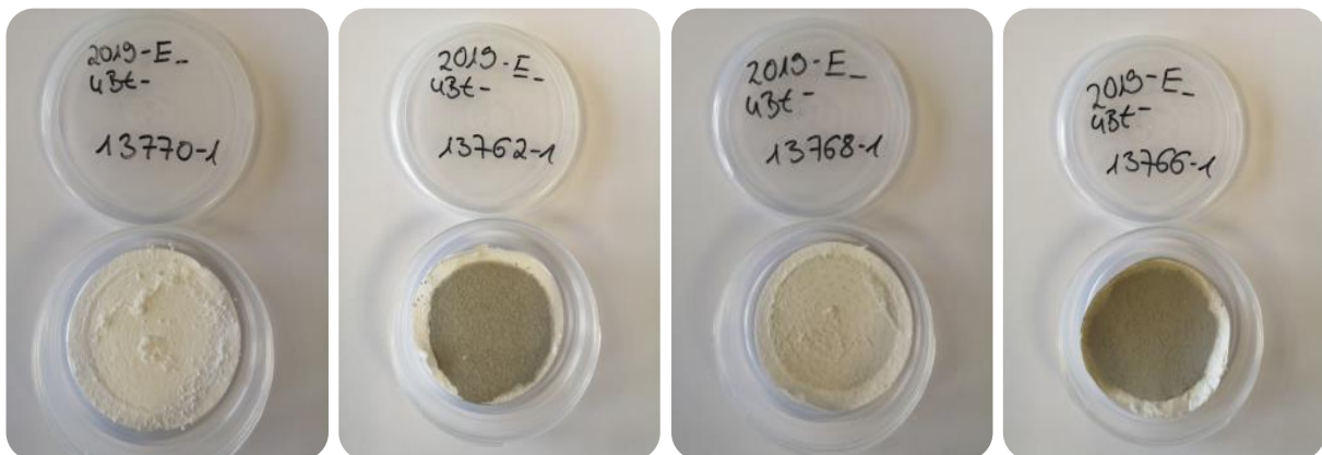
Abbildung 97: Aufnahmen der unlöslichen Rückstände eines Mineralsäure-Aufschlusses mit HCl (vlnr: Klinker, Filterstaub, Heißmehl, Rohmehl).
