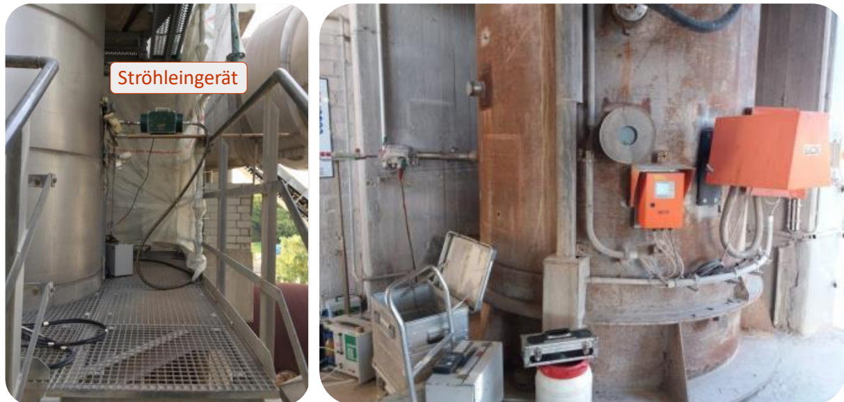
Abbildung 39: Messstellen im Rohgas (links) und Reingas (rechts).
