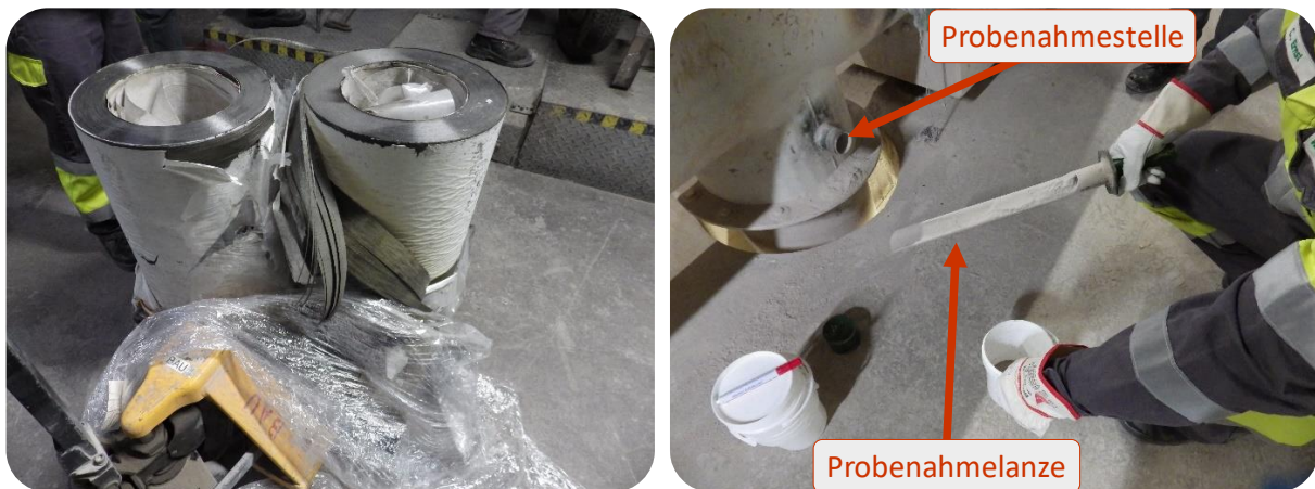
Abbildung 34: Eingesetztes Prepreg-Material (links), Probenahme Gewebefilterstaub (rechts).
