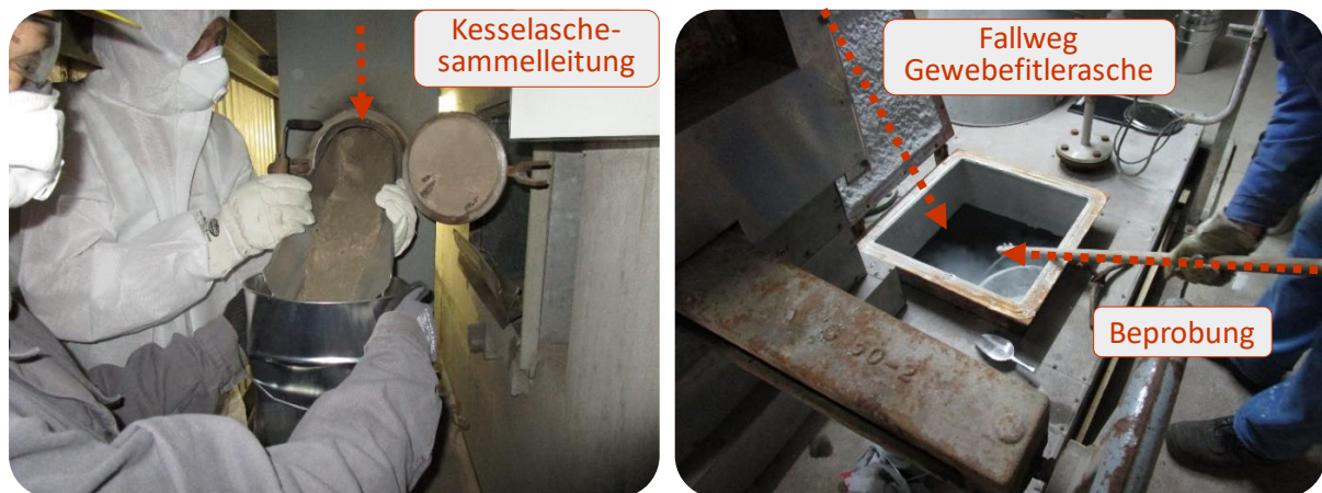
Abbildung 20: Beprobung der Kesselasche (links) und des Gewebefilterrückstands (rechts).
