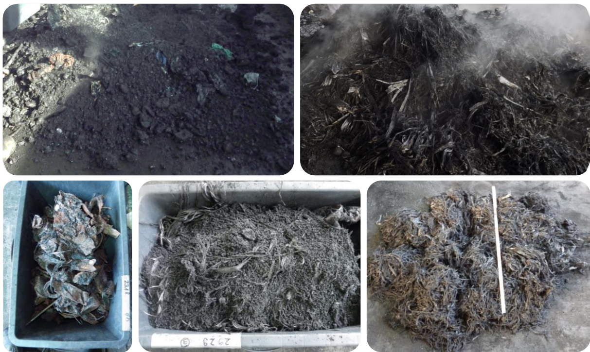
Abbildung 78: Schlacken im Versuchszeitraum Referenz (links oben) und CF-Mitverbrennung (rechts oben). Unten: aussortierte Metalle > 30 mm (links), Schlacke (Mitte) und aussortierte CF > 30 mm (rechts) beim Versuch unter CF-Mitverbrennung.
