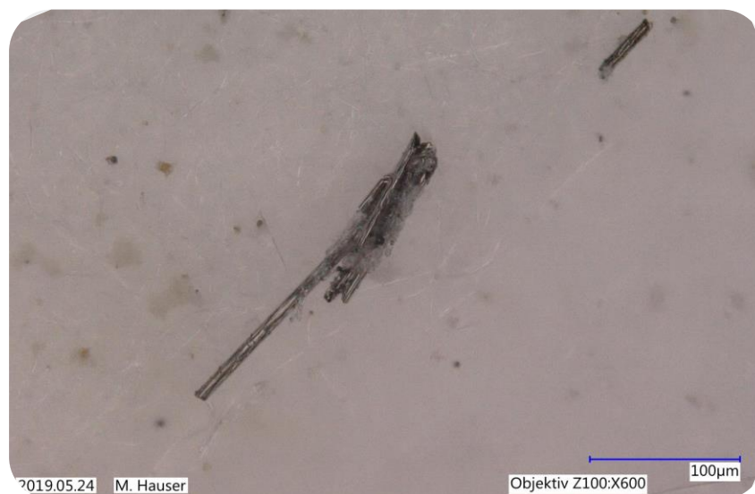
Abbildung 112: Carbonfasern im Reingas der Schwadenabluft nach dem Gewebefilter, während der Versuchswoche unter Zugabe von 5 Mg CFK Pellets/d.
