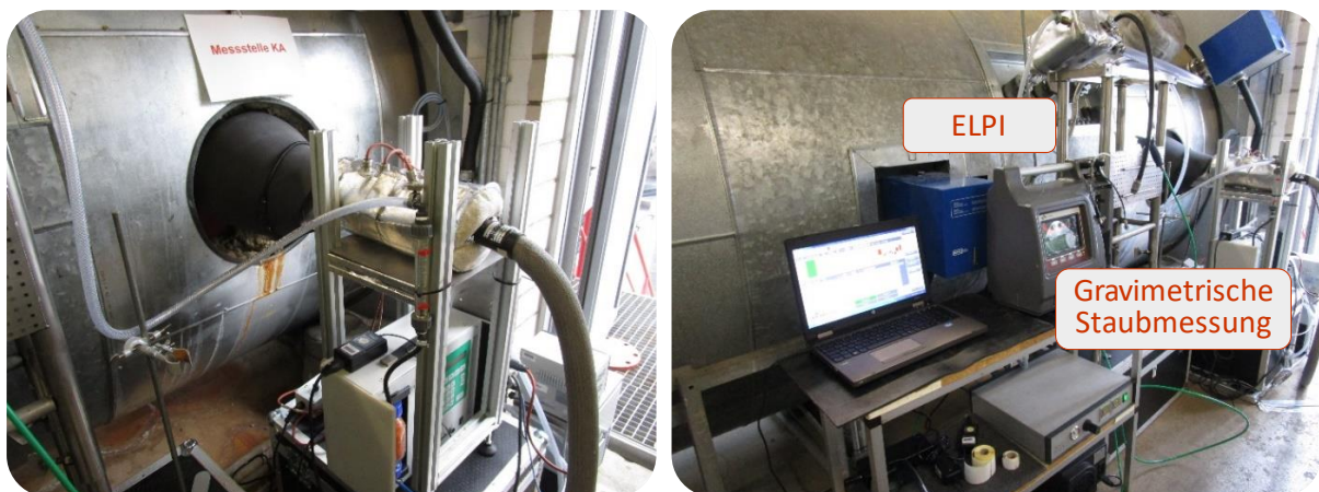
Abbildung 23: Aufbau der Messungen am Kamin.
