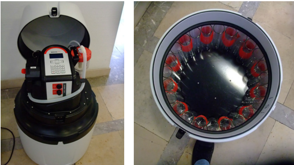
Abbildung 15 Mobiler automatischer Probensammler P6 L der Firma MAXX Mess- und Probenahmetechnik GmbH, Rangendingen)
