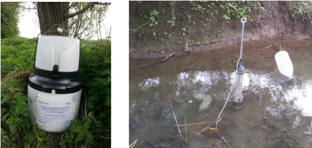
Abbildung 17 Mobile automatische Probenahme im Gelände
