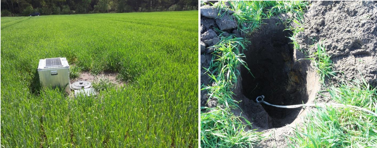
Abbildung 38: Aufbau der Saugsondenanlage an der BDF Markhausen mit Saugkerze & Sammelflasche (Schema: LBEG)
