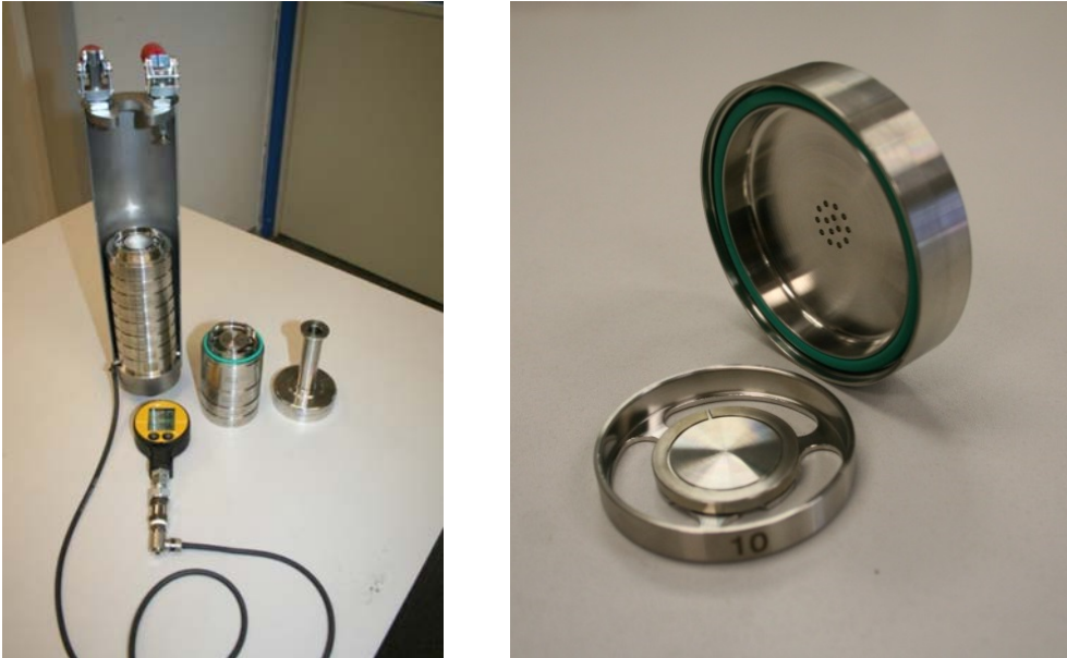
Links: Teilzerlegter Kaskadenimpaktor von Dekati, Rechts: Einzelne Stufe des Impaktors
