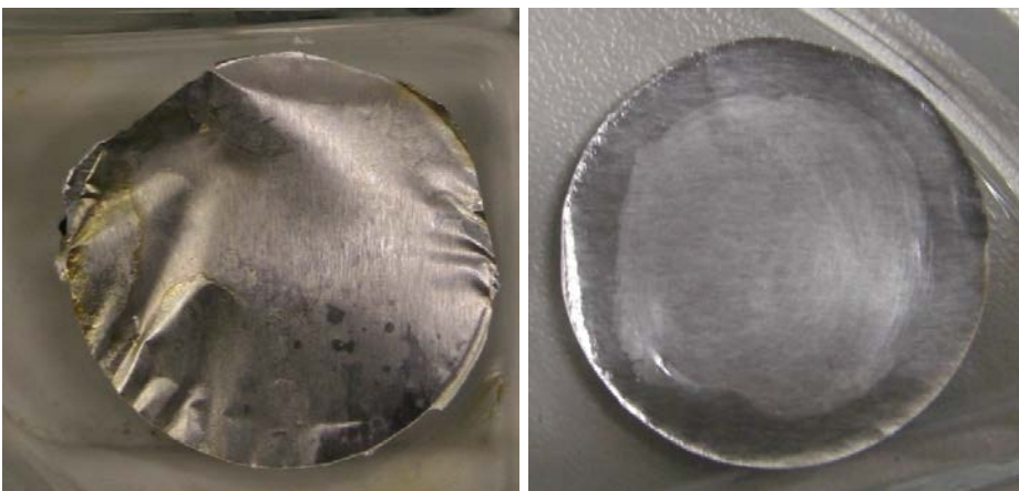
Beschichtete Aluminiumfolien für die Impaktorstufen nach den Probemessungen am GKS ohne (l.) und mit (r.) hochtemperaturbeständigem Fett
