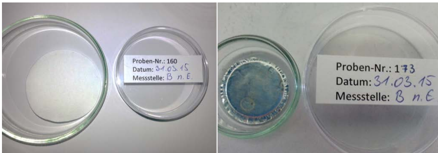
Teflon-Filter (links) und Stufe 13 mit Kondensat (rechts), erste Referenzmessung nach E-Filter
