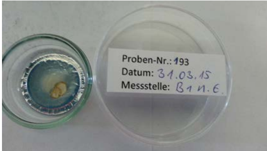
Bildung von Kondensat: Stufe 13 mit Kondensat erste Referenzmessung nach E-Filter
