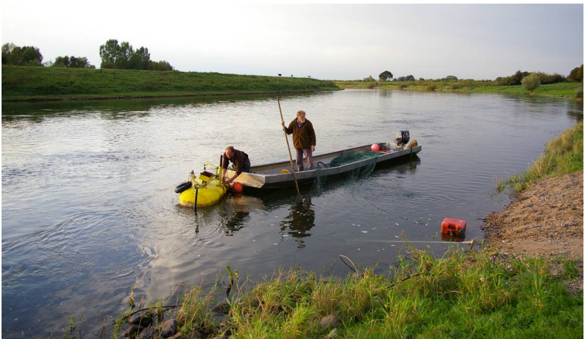
Abb. 12: Durch Umlegen des Steuerblattes driftet das Scherbrett selbsttätig vom Ufer in Flussmitte
