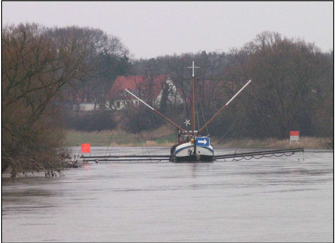
Abb. 3: Schokker des Fischereibetriebs der Gebrüder Dobberschütz von vorne, in Ruhestellung mit angehobenem Unterbaum
