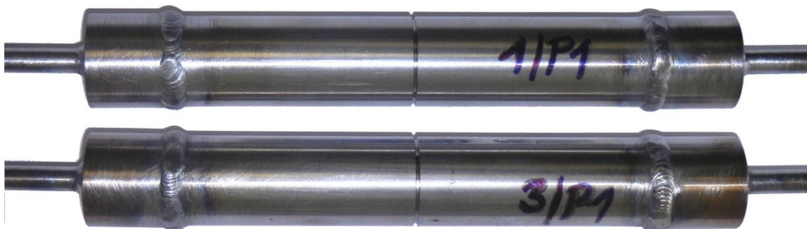
Abbildung 99: Proben 1|P1 und 3|P1 mit Umfangskerbe
