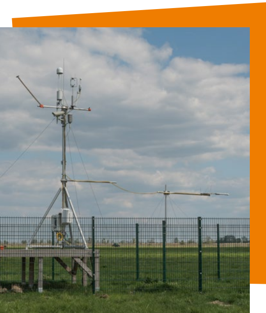
Treibhausgas-Messstation in einem Niedermoor
