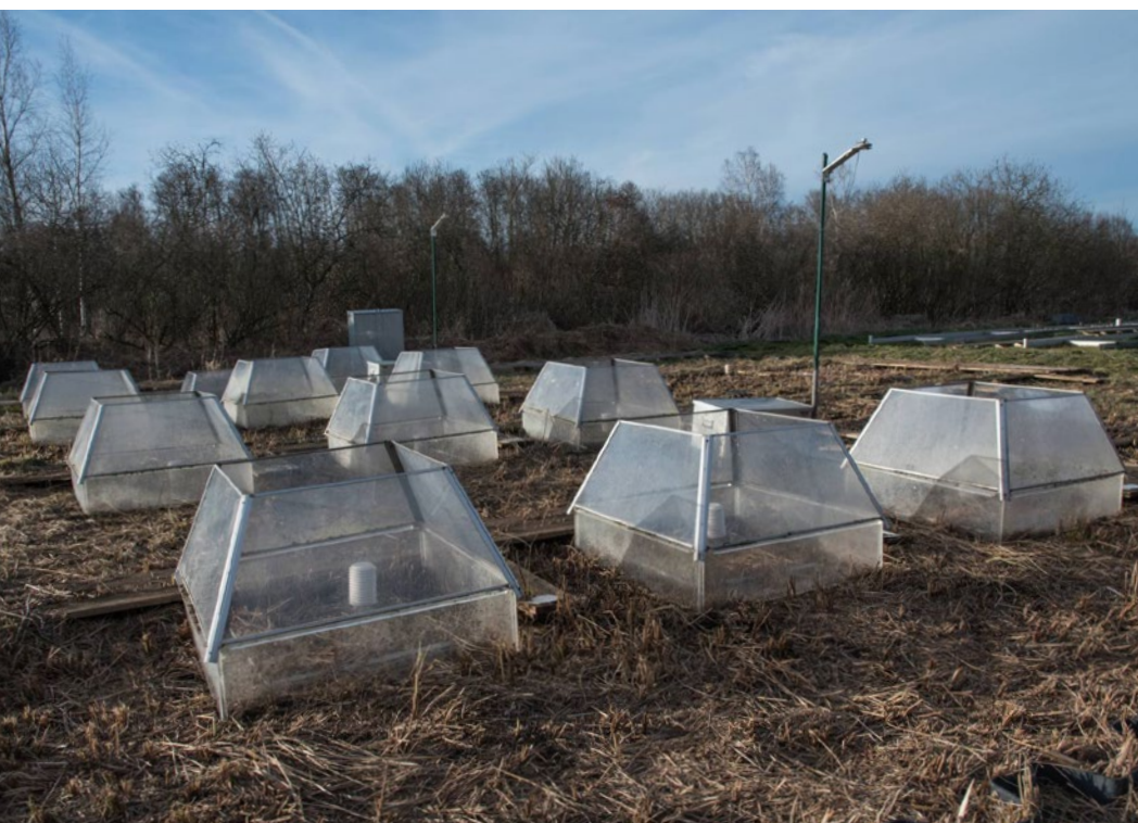
Versuchsfläche zur Ermittlung von Treibhausgas-Emissionen in einem Niedermoor
