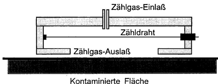
Abb. 14: Schematische Darstellung eines offenen Zählrohres (z. B. zur Messung von H-3-Kontaminationen)
