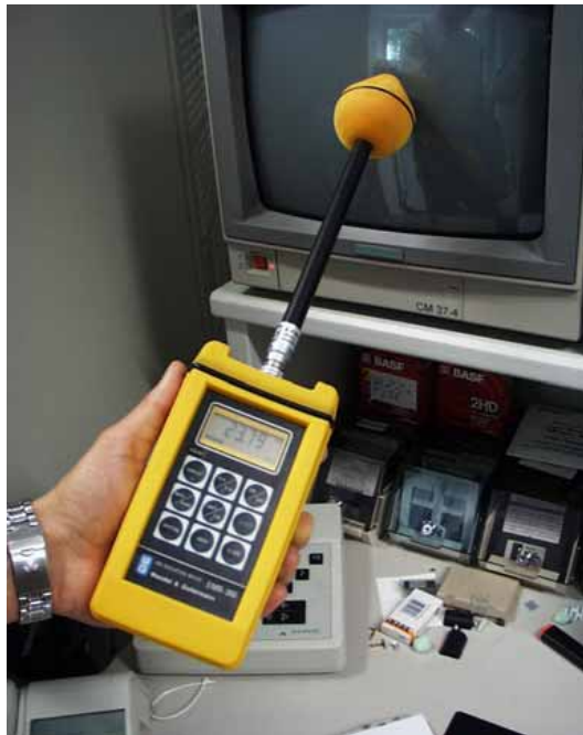
Bild I.4.2 Breitbandiges Feldstärkemessgerät mit aufgesteckter Messsonde
