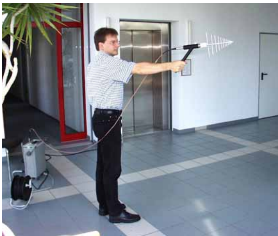
Bild I.4.1 Frequenzselektives Messverfahren mit Spektrumanalysator und Messantenne
