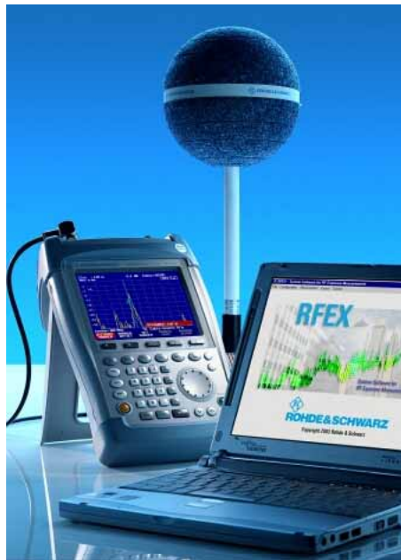
Bild II.4.14: Langzeitmessungen: Isotropes Messsystem TS-EMF von Rohde & Schwarz
