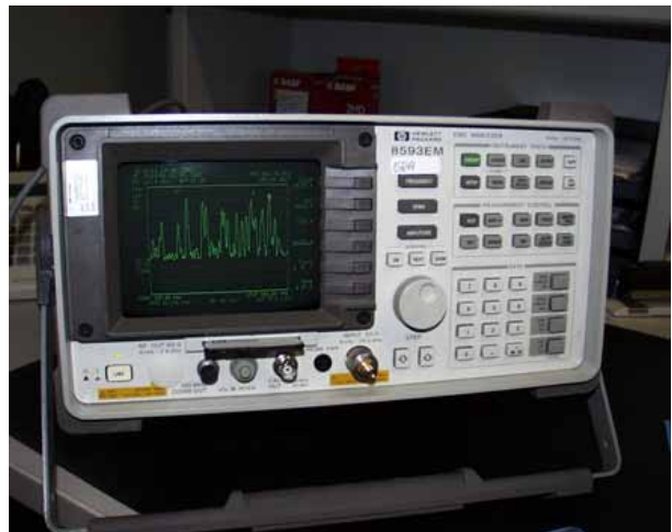
Bild I.4.1 Frequenzselektives Messverfahren mit Spektrumanalysator und Messantenne
