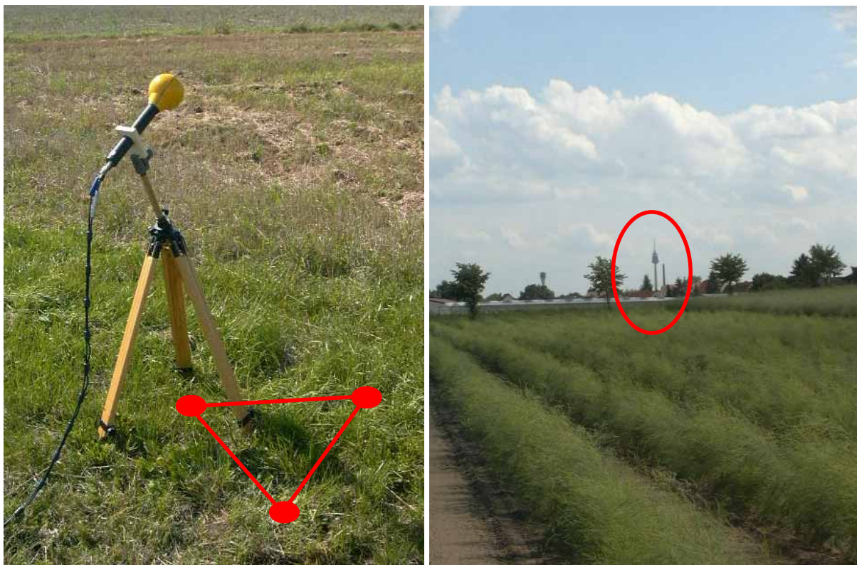
Bild II.4.1: Messaufbau "Einzelpunktmessung" mit isotroper Antenne (links) und Fernmeldeturm Nürnberg (rechts)
