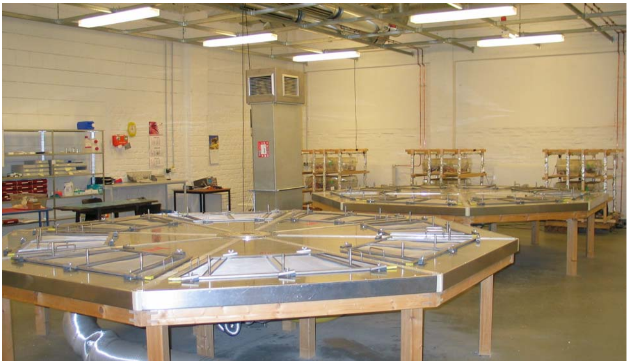
Bild 4: Ansicht der beiden umgerüsteten Expositionseinrichtungen mit der zentralen Belüftungsanlage
