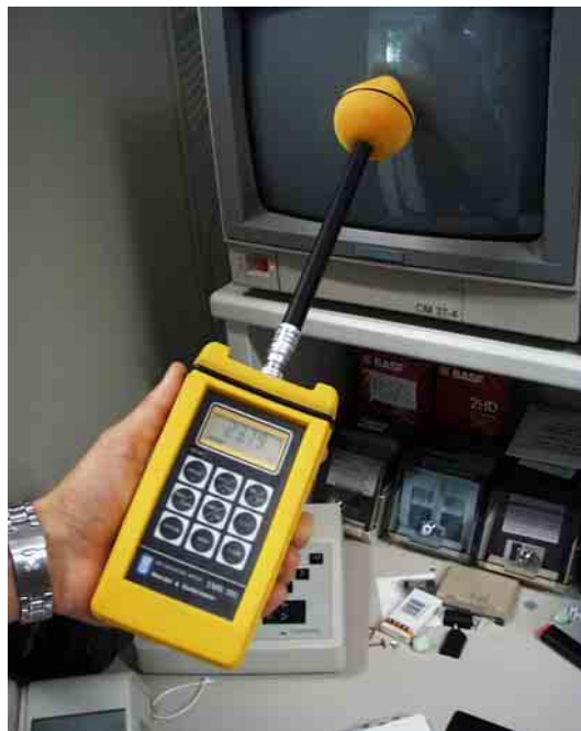
Bild 2.5.8 Breitbandiges Feldstärkemessgerät mit aufgesteckter Messsonde
