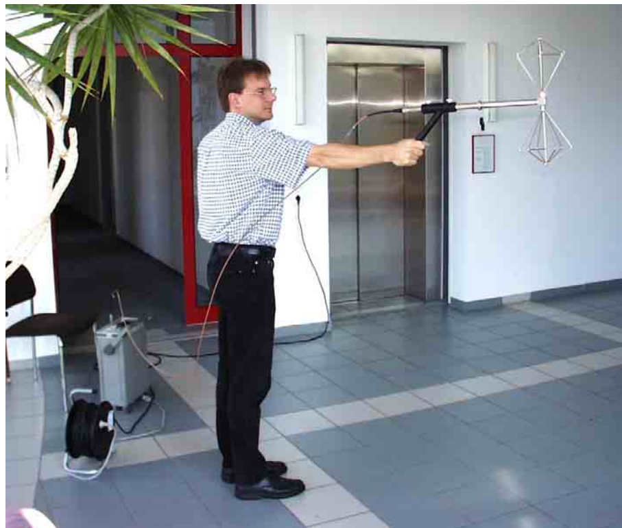
Bild 2.5.11 Durchführung der Schwenkmethode mit bikonischer Antenne in Halterung
