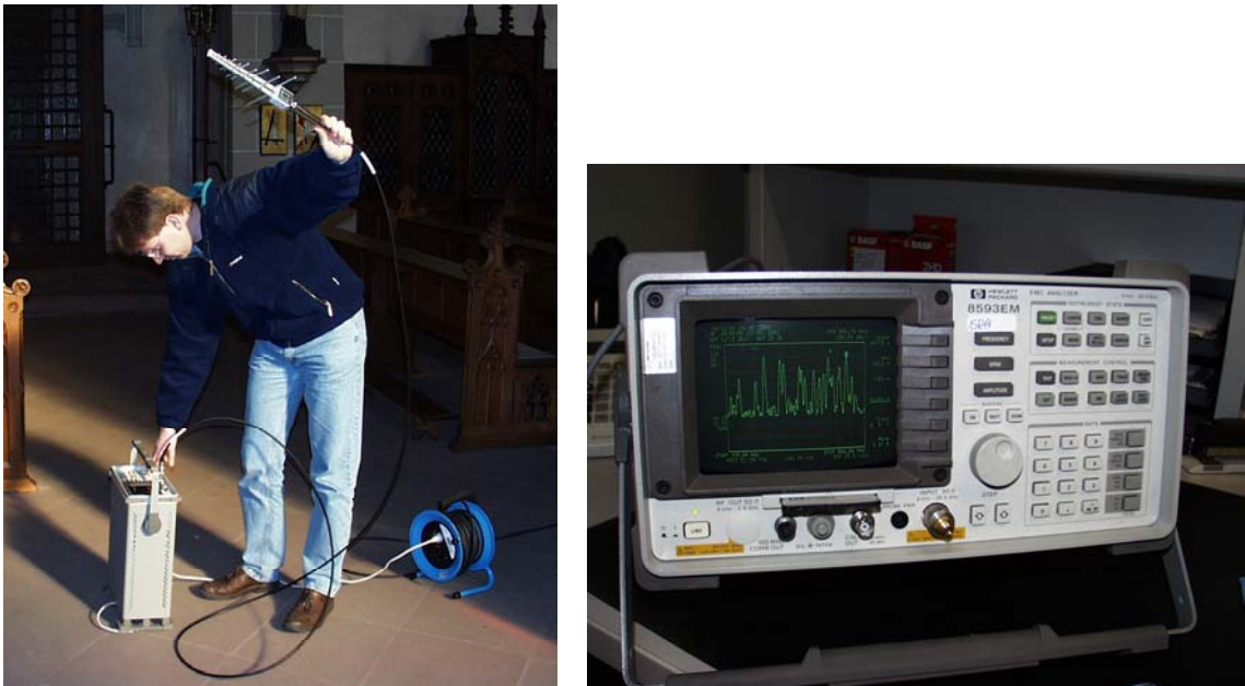
Bild 3.1 Durchführung einer frequenzselektiven Messung mit Spektrumanalysator und Empfangsantenne (links) und Detaildarstellung eines Ergebnisses auf dem Spektrumanalysator (rechts)
