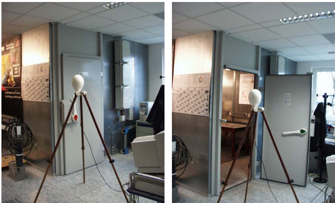
Bild 4.2.1 Untersuchter Laborbereich mit geschlossener und geöffneter Schirmkammertür ohne direkte Sicht zur Basisstation
