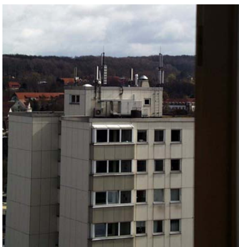
Bild 2.2.26 Erhöhung der Immission in der Gebäudemitte durch Reflexion am Nachbarhochhaus. Das benachbarte Hochhaus ist links dargestellt und verfügt auch über eine Sendeanlage, deren Anteil hier aber ausgeklammert wird
