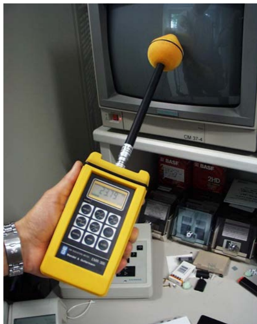
Bild 3.2 Breitbandiges Feldstärkemessgerät mit aufgesteckter Messsonde
