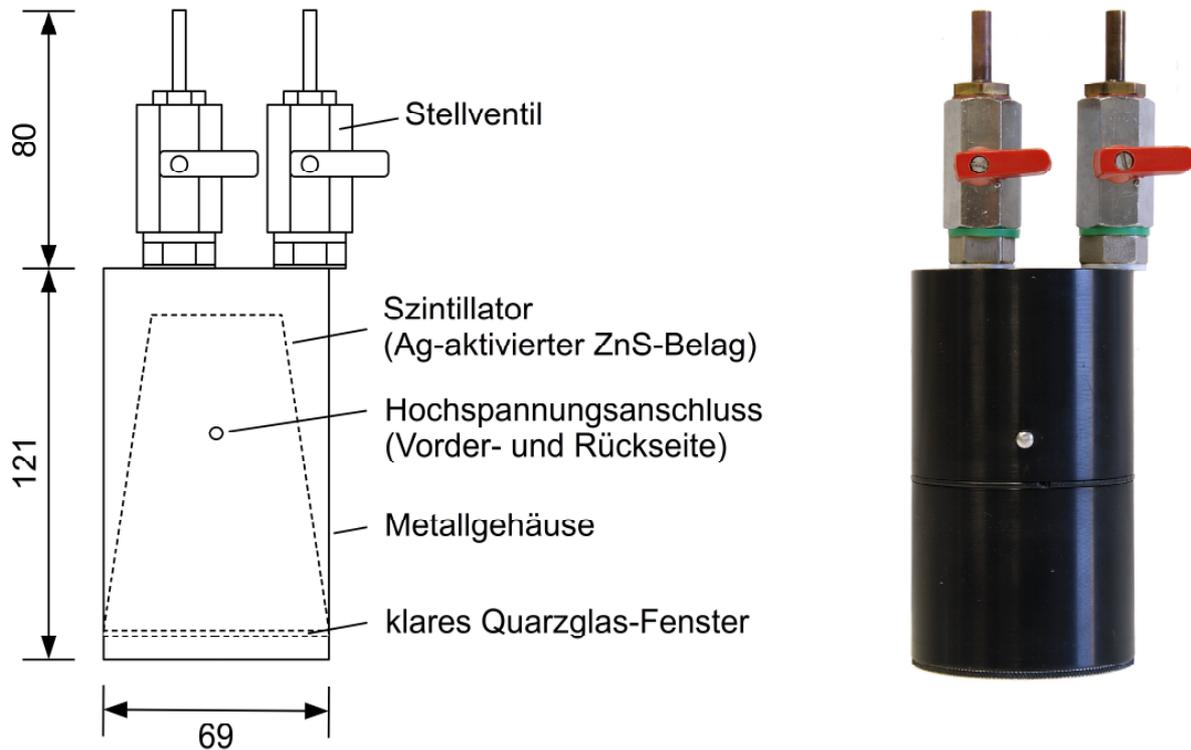
**Abb. 1:** Lucas-Kammer (Abmessungen in mm)
