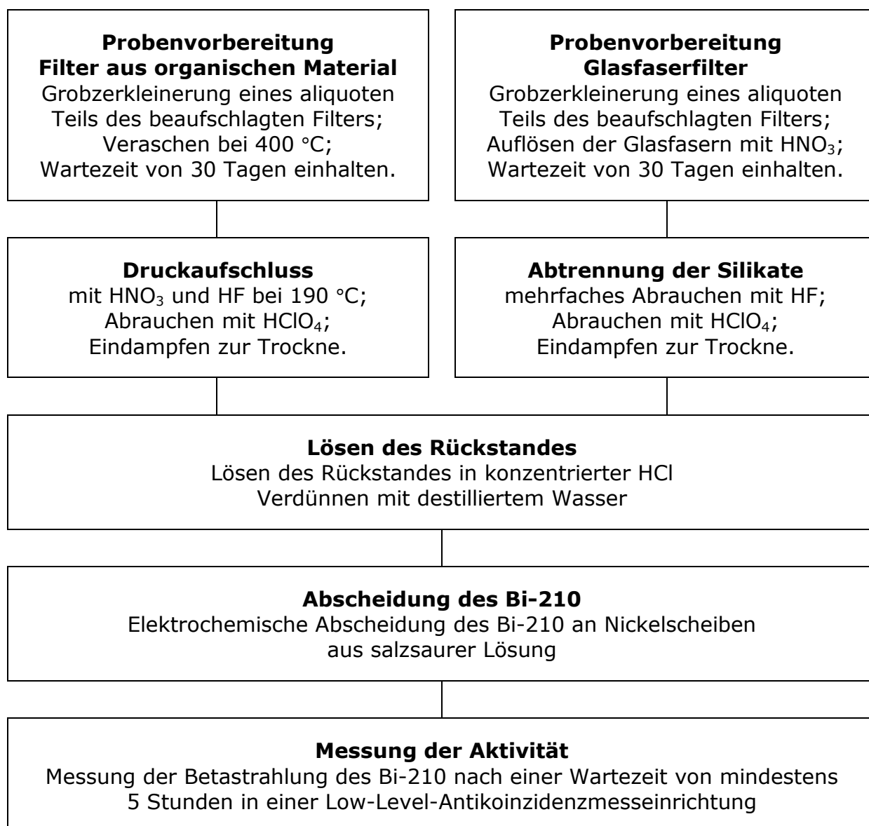
Abb. 1: Prinzip der Bestimmung der aerosolpartikelgetragenen Pb-210-Aktivitätskonzentration
