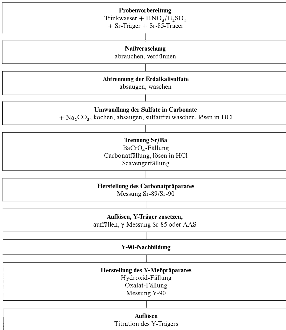
Abb. 1: Prinzip der Bestimmung von SR-89/Sr-90 im Trinkwasser
