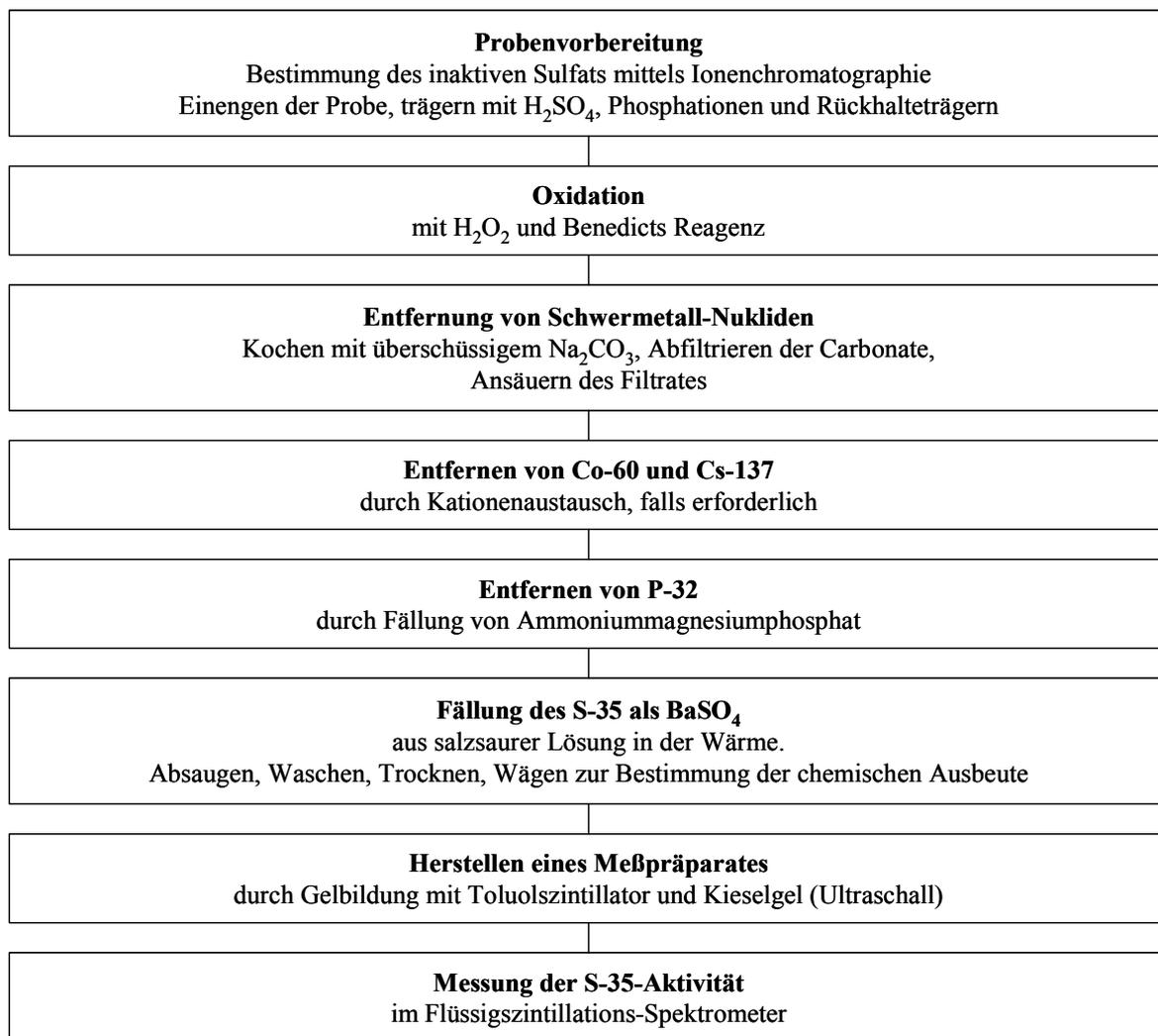
**Abb. 1:** Prinzip der Bestimmung von S-35 im Abwasser
