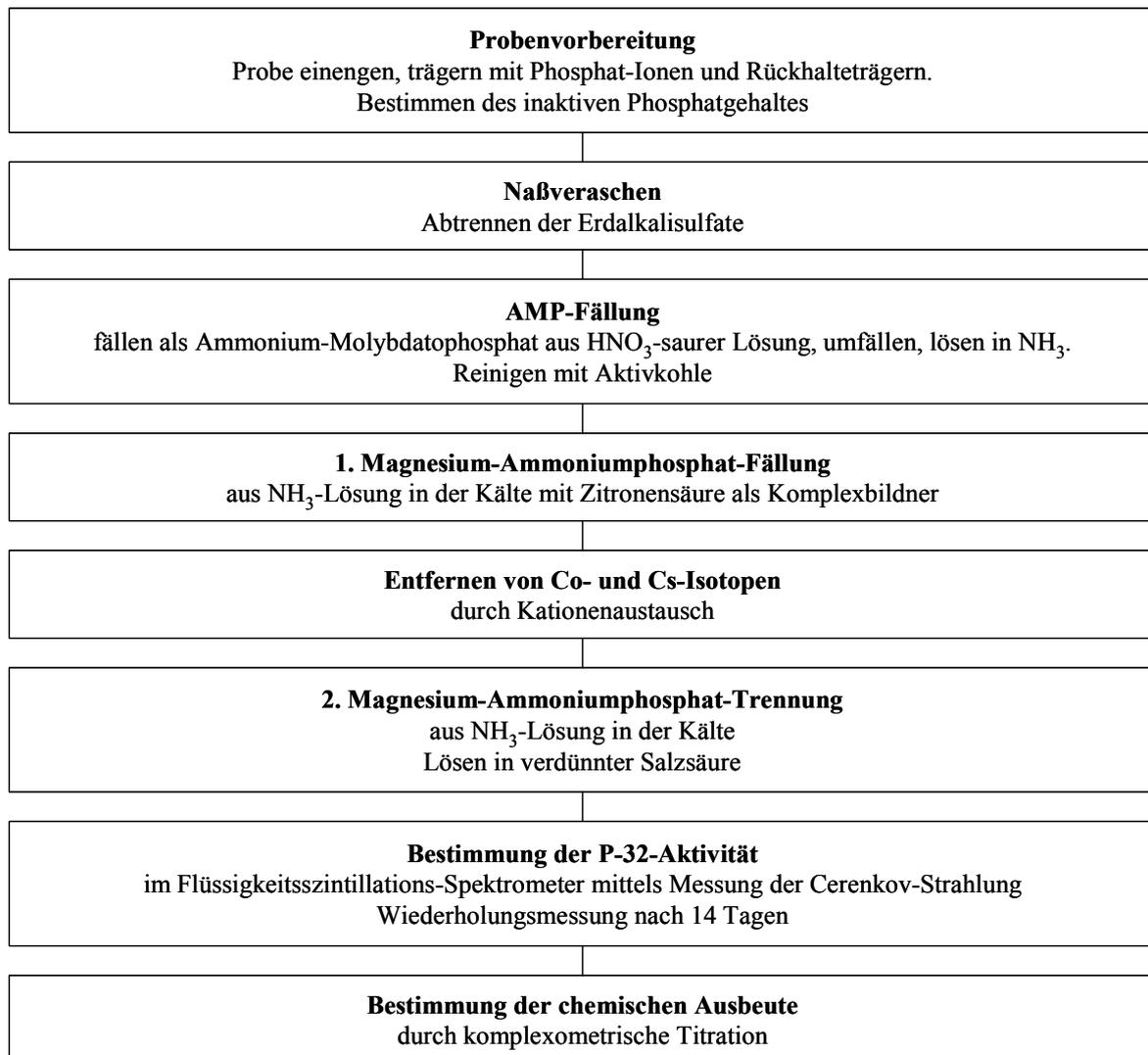
**Abb. 1:** Prinzip der Bestimmung von P-32 im Abwasser
