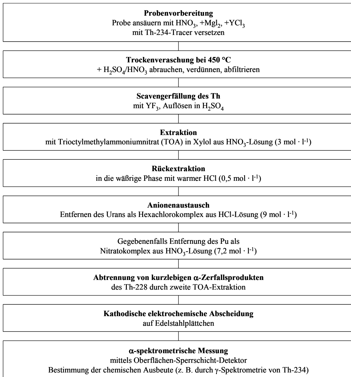
Abb. 1: Prinzip der Bestimmung von Thoriumisotopen im Abwasser
