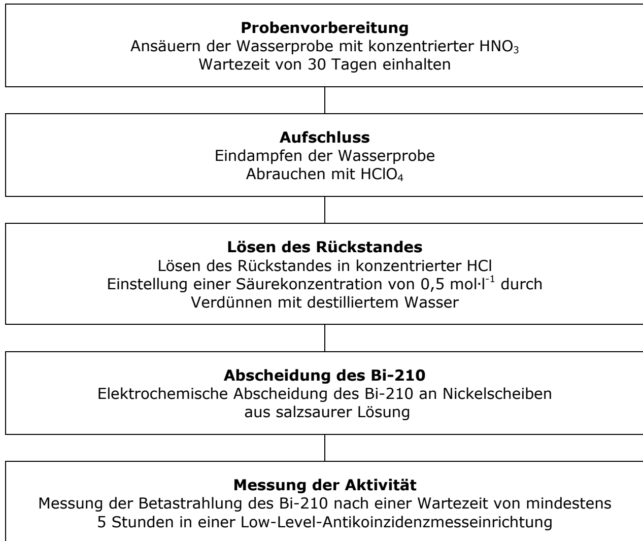
Abb. 1: Prinzip der Bestimmung von Pb-210 in Wasserproben
