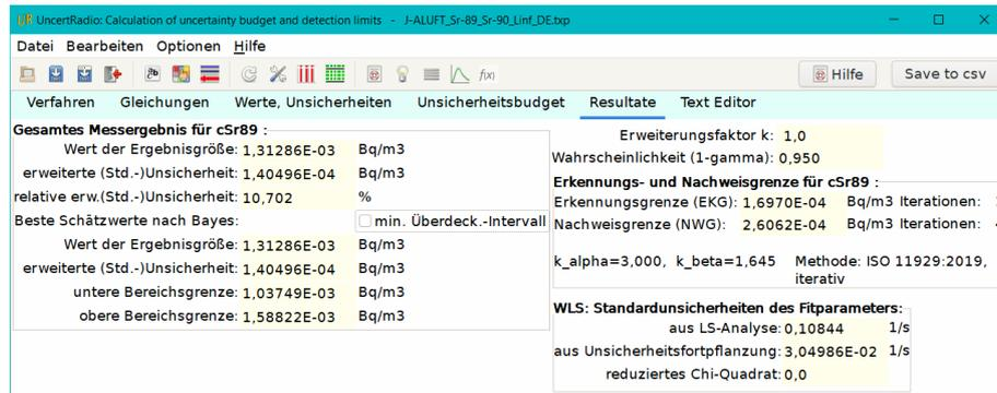
**Abb. B11:** Resultatseite für die Aktivitätskonzentration von Strontium-89 nach Anwendung der linearen Entfaltung
